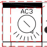
Calibrer le disjoncteur en fonction de la puissance de la pompe
