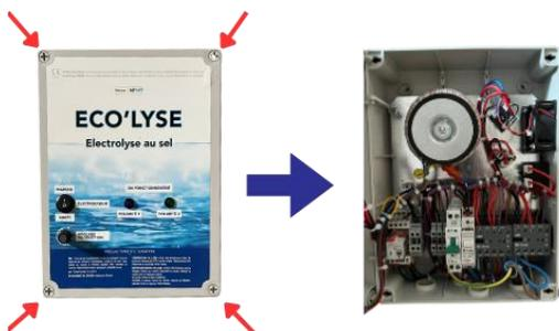
B - Présenter le boîtier sur le tableau en avant les pas de vis
