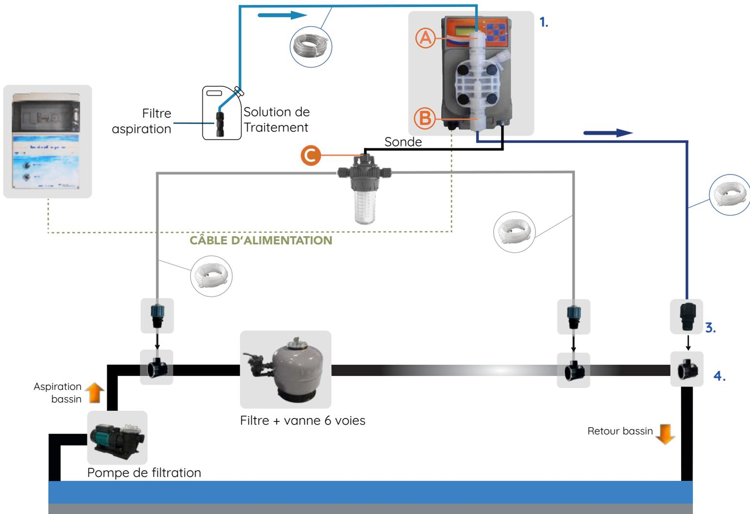
**LE TABLEAU DE RÉGULATION DOIT ÊTRE IMPÉRATIVEMENT ASSERVI ÉLECTRIQUEMENT À LA POMPE DE FILTRATION**
