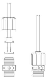
**E Aspiración:** Conectar al otro extremo del tubo PVC Crystal a la aspiración de la bomba (racor inferior del cuerpo de la bomba), desenroscar la tuerca desde el racor y pasar el tubo a través de la tuerca también el adaptador y por fin insertar hasta el final con una acción contemporánea de presión y rotación el tubo sobre el ataque cónico bloquear apretando firmemente la tuerca.
