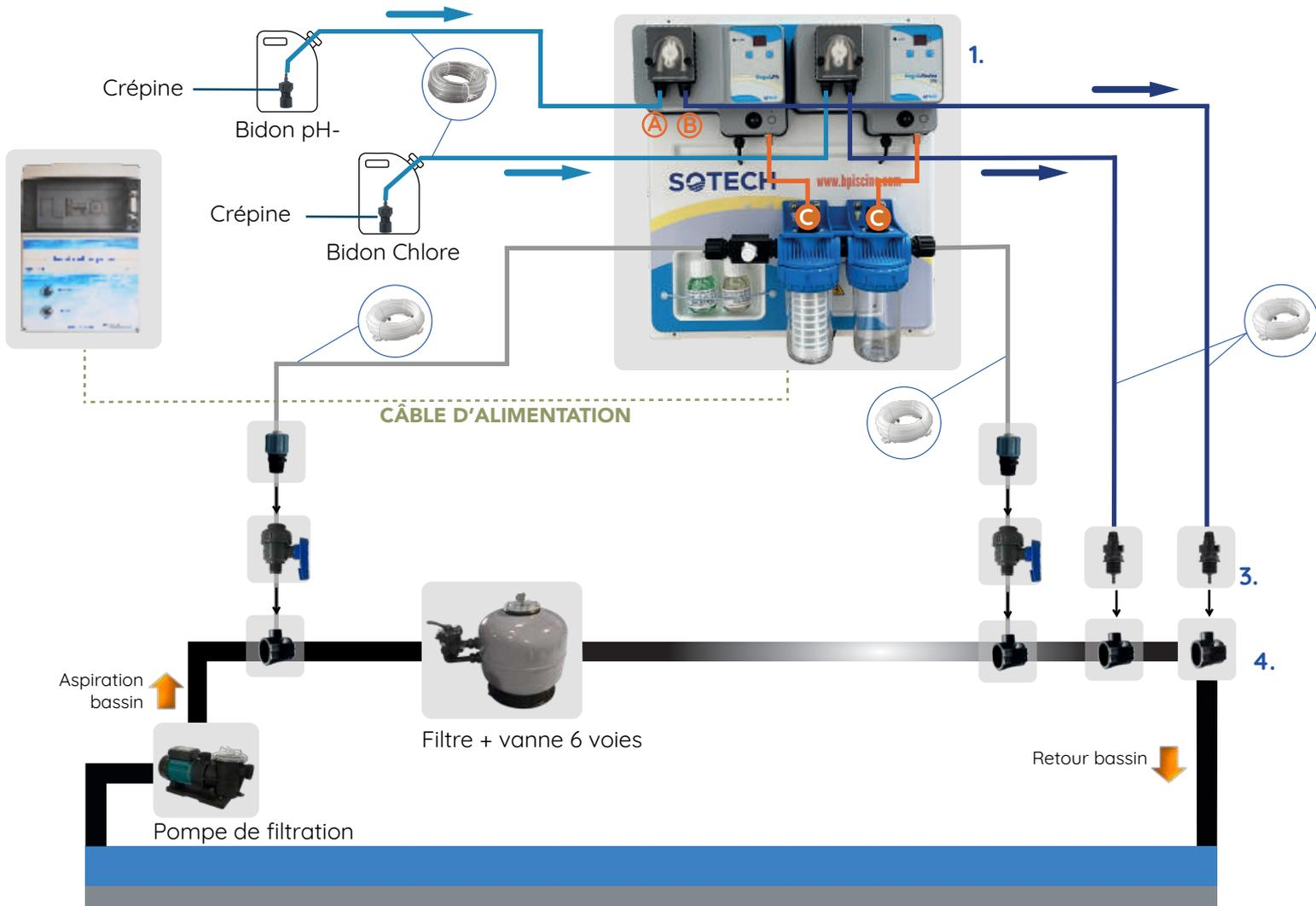
**LE TABLEAU DE RÉGULATION DOIT ÊTRE IMPÉRATIVEMENT ASSERVI ÉLECTRIQUEMENT À LA POMPE DE FILTRATION**
