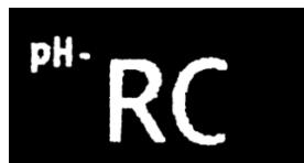
**FR** Si à la fin de l'étalonnage le display affiche "rc", appuyer sur le bouton Cal pour revenir à la lecture. Répéter la procédure d'étalonnage, si le message "rc" réapparaît, cela signifie que l'électrode n'est pas en bon état et qu'elle doit être changé.
