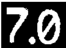
**FR** Appuyer pendant 3 secondes sur le bouton CAL, la valeur 7.0 commencera à clignoter sur le Display. L'étalonnage du pH 7.0 est automatique et il se termine quand la valeur sur le Display redévient fixe
