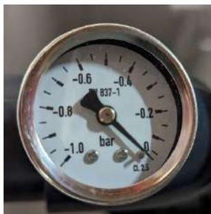
**Exemple :** à la mise en route de la filtration, si le manomètre affiche -0,4, alors la cartouche devra être nettoyée dès que le manomètre affichera -0.7.
